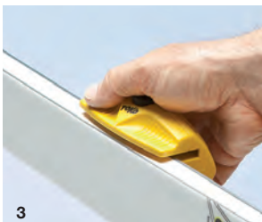
Abb. 4) Grate entfernen. Beim Feilen entstehen Grate. Diese werden mit den Diamantfeilen rot oder grün entfernt. In Wasser eingetaucht, lassen sich die Diamantfeilen leichter über die Kante ziehen (Reibungsverminderung).
